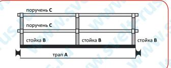
Комплект ограждений можно быстро собрать он состоит из 2 стоек **B** и 2 поручней **C** с каждой стороны платформы (для моделей BR06, BR07 и BR08 он состоит из 3 стоек).
